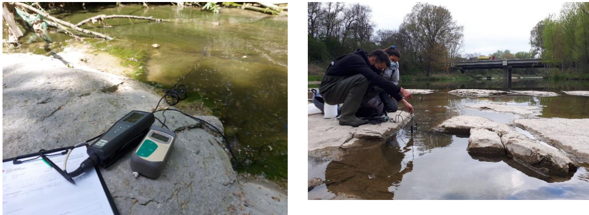
Figura 5. Sondes portàtils per a la mesura de la conductivitat elèctrica, el pH, la temperatura i l'oxigen dissolt a l'aigua, per a la presa de dades in situ a cada punt de mostreig.
