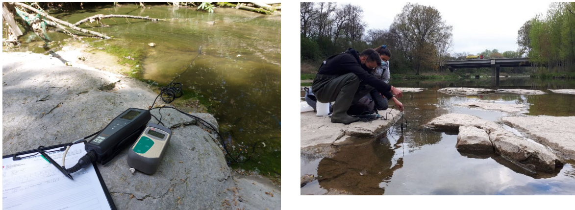
Figura 5. Sondes portàtils de conductivitat elèctrica, pH, temperatura i oxigen dissolt, per a la presa de dades in situ a cada punt de mostreig.
