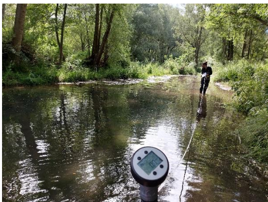
Figura 3. Mesura de la velocitat de l'aigua amb un correntòmetre de molinet –model FP101 de Global Water- i presa de dades de l'amplada i la profunditat, al riu Ter, per obtenir-ne el cabal.
