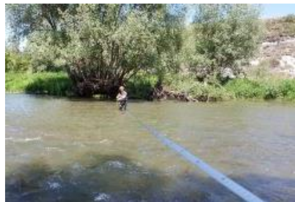
Figura 3. Mesura de la velocitat de l'aigua amb un correntòmetre de molinet –model FP101 de Global Water- i presa de dades de l'amplada i la profunditat, al riu Ter, per obtenir-ne el cabal.
